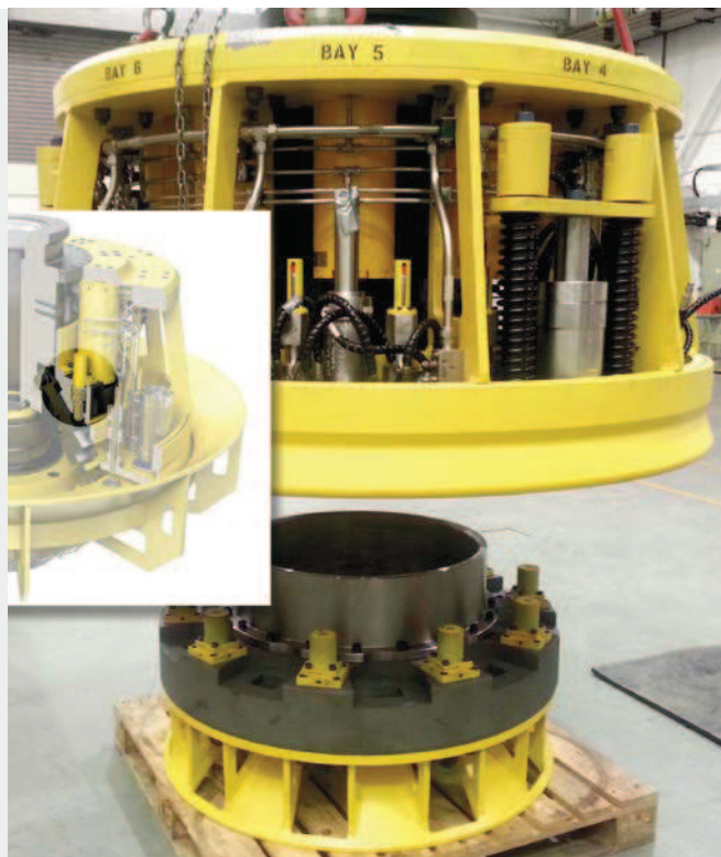
Tlumiče MAGNUM umožňují v případě nouze rychlé oddělení potrubí od vrtací hlavy.
